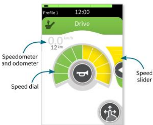
Figure 56 : Carte de conduite montrant le compteur de vitesse / odomètre, le cadran de vitesse et le curseur de vitesse
